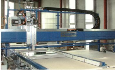
50 Prozent der Kunststoff-Fenster werden mit verklebten Scheiben ausgeliefert. Im Bild der neue Automat zur Scheibenverklebung.
